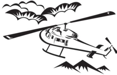
Das ist ein Hubschrauber. Der Hubschrauber kann überall starten und landen, er braucht keine Start - und Landebahn. Er hat einen dynamischen Auftrieb, er fliegt, indem seine Tragschraube rotiert.
