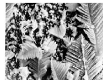
Дендрит Zn, полученный электрохимическим осаждением
