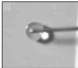
Рисунок 2.11. Формирование калиброванной капли за 1 мс до падения
