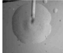
Рисунок 2.16. Растекание капли по некачественно очищенной поверхности. Время растекания 12 мс
