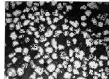
WC планкированный никелем, x200
