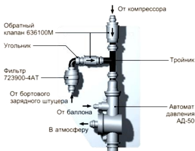
Рис. 2.5 – Расположение агрегатов на пневмопанели
