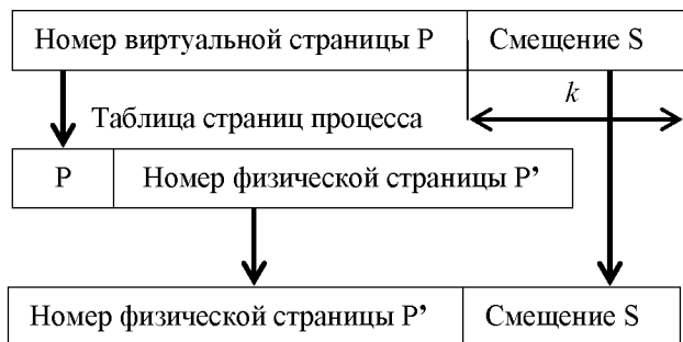
Рис. 10.6. Схема преобразования адреса при страничной организации памяти
