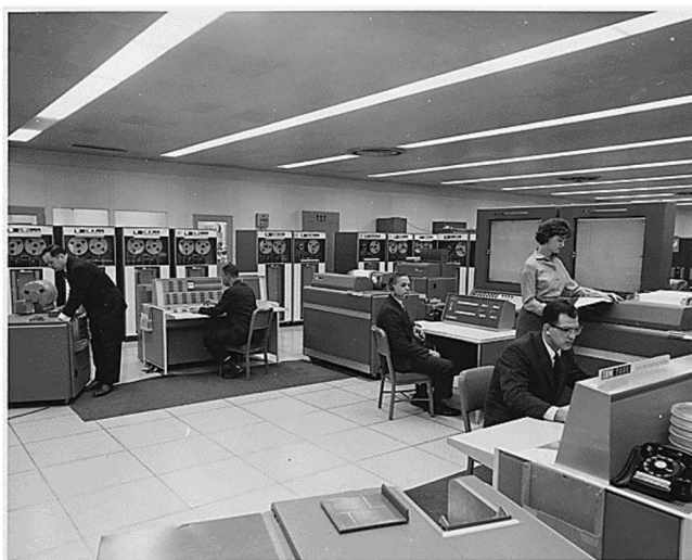
Рис. 1.1. Машинный зал с компьютером IBM 7094, НАСА. На переднем плане, внизу – считыватель перфокарт
