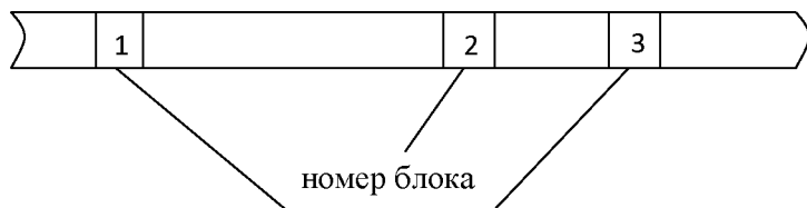
Рис. 13.2. Последовательность блоков переменной длины
