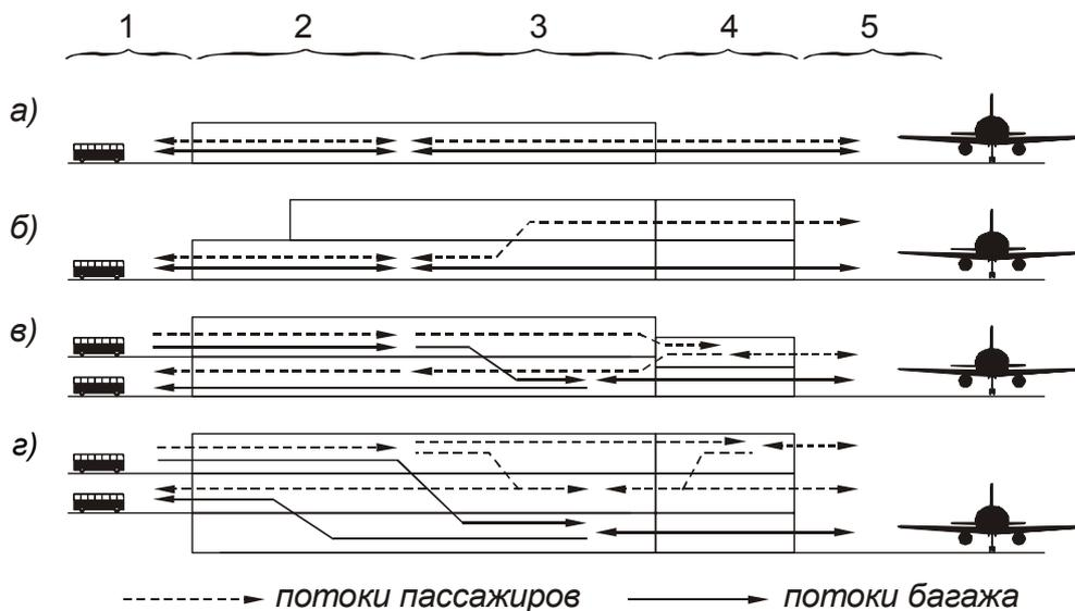
**Рис. 1.7. Аэровокзалы с различным числом ярусов**
