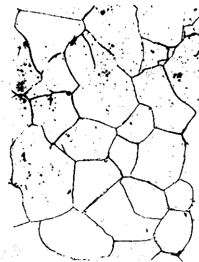
Рис. 12. Феррит, \times 500 — тв.р-р углерода в \alpha -железе; кристаллическая решетка ОЦК; способен растворять до 0,025% С; образуется из аустенита
