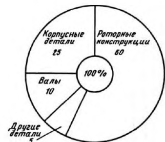
Рис. 47. Основная номенклатура узлов ГТД, свариваемых электронным лучом
