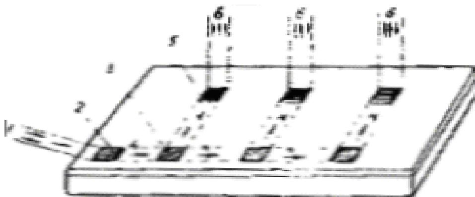
Рис. 7.23. Интегрально-оптическая разводка: 1 – входной световой луч; 2 – вводная дифракционная решетка; 3 – планарный ответвитель; 4 – световые лучи в волноводном слое; 5 – экспланарный ответвитель; 6 – выходные световые лучи
