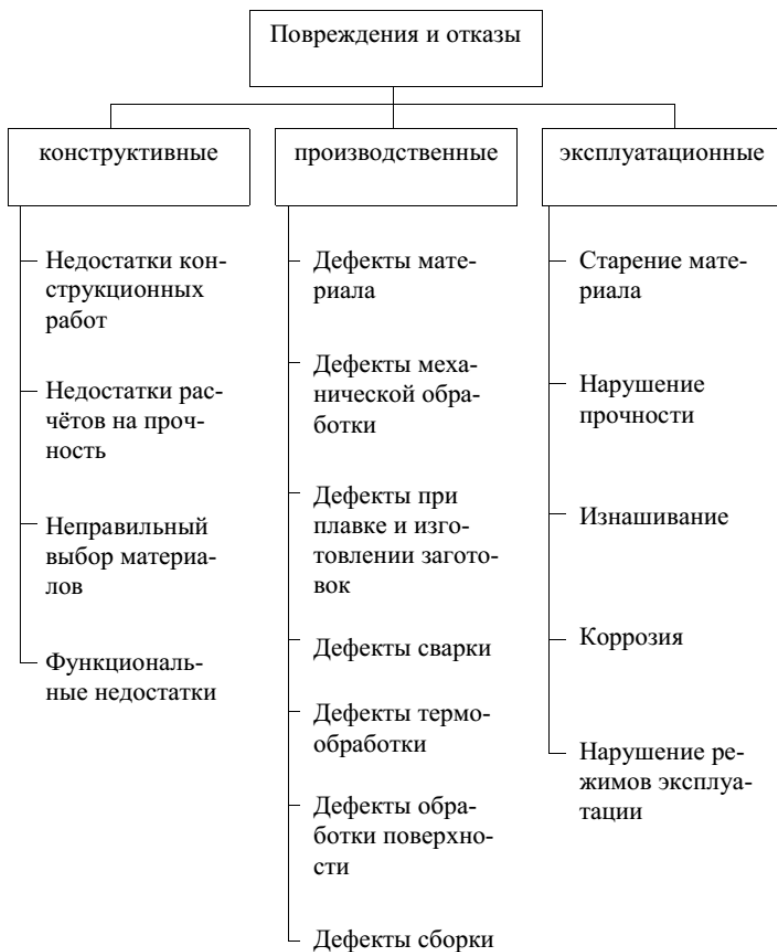
Рис. 5. Виды повреждений и отказов
