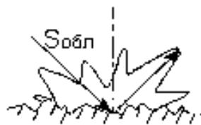
Рис. 3.7 Диаграмма отражения реальной земной или водной поверхности
