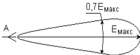
Рис. 4.17 Диаграмма направленности многовибраторной антенны
