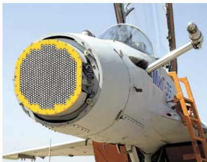
Рис.4.53 Вид АФАР, размещённой на самолёте
