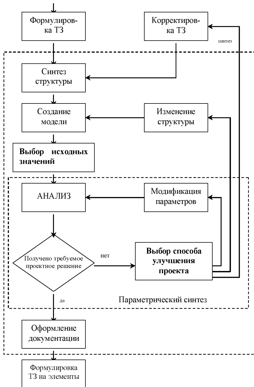
Рис. 2.3 – Схема процесса проектирования
