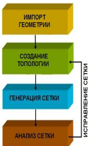
Рис. 2.1. Процесс создания расчетных моделей турбомашин с помощью TurboGrid
