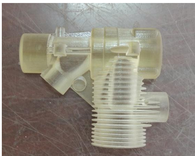
Рисунок 81 – Изготовленный прототип картера ДВС тягой 2 л.с.
