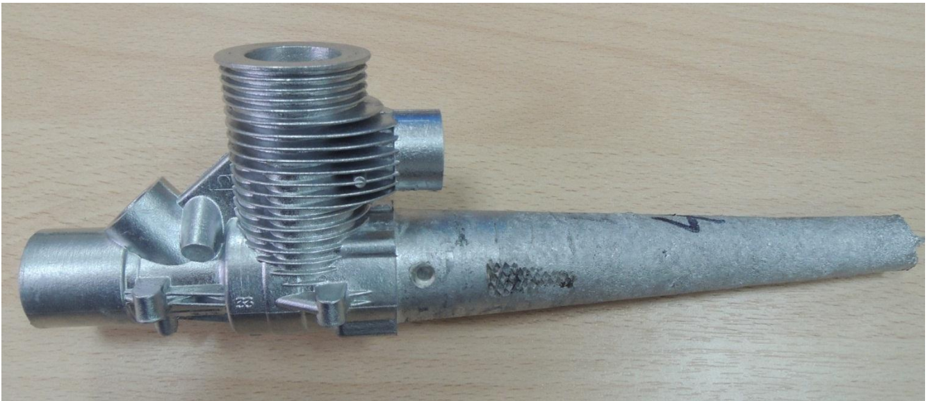
Рисунок 67 – Картер ДВС, полученный методом литья в кокиль
