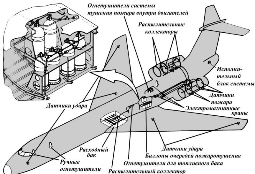
Рис. 56. Пример компоновки противопожарной системы.
