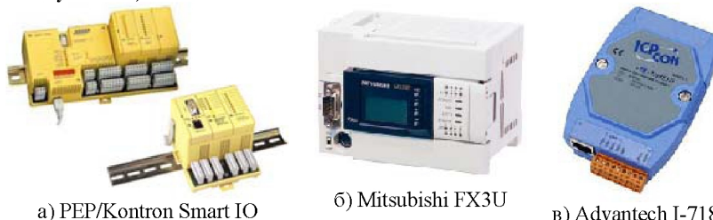
Рис. 2.14. Примеры промышленных и программируемых логических контроллеров
