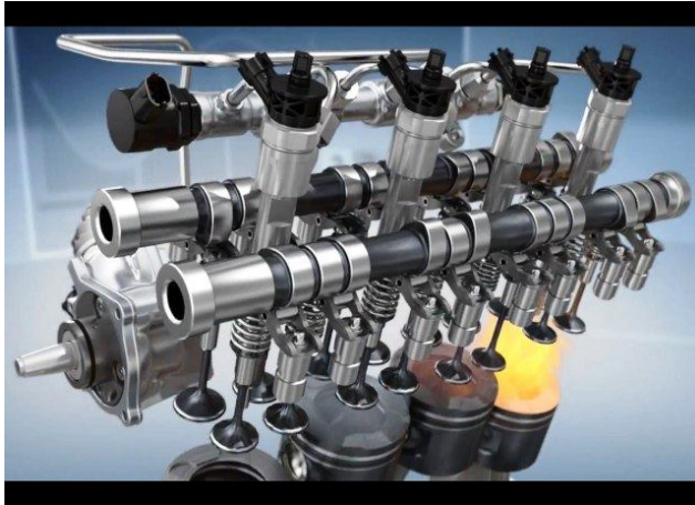
Рис. 4.7. Работа компонентов ГРМ 3D-модели ДВС в процессе симуляции
