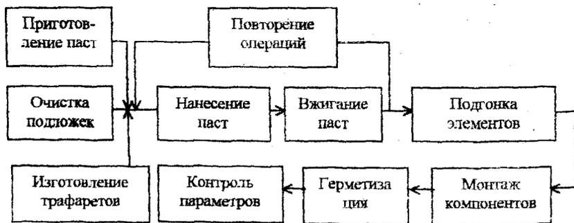
Рис.6. Схема технологического процесса изготовления толсто пленочных микросхем
