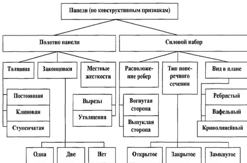
Рис. 4. Конструктивная классификация панелей
