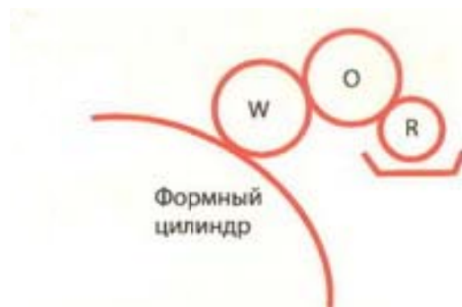
Рис. 61. Увлажняющий аппарат косвенного действия (система увлажнения Dahlgren), валики: дукторный ( R ), накатной ( W ) и раскатной ( O )
