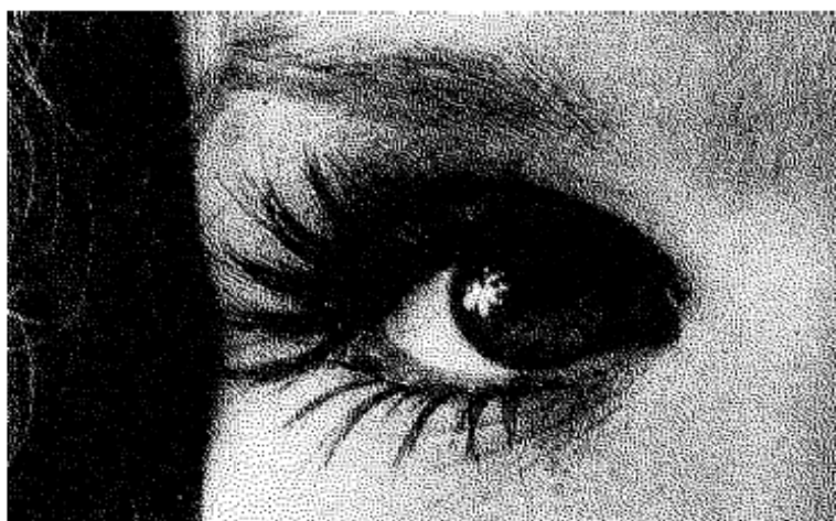
Рис. 3. Изображения, полученные с применением различных растровых структур: а – периодический растр (амплитудно-модулированный); б – непериодический растр (частотно-модулированный)
