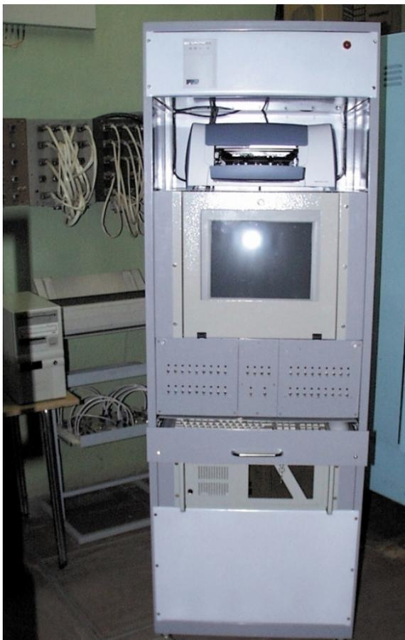
Рисунок 3.18 – Общий вид автоматизированной системы управления и информационного обеспечения испытаний и исследований ЖРДМТ
