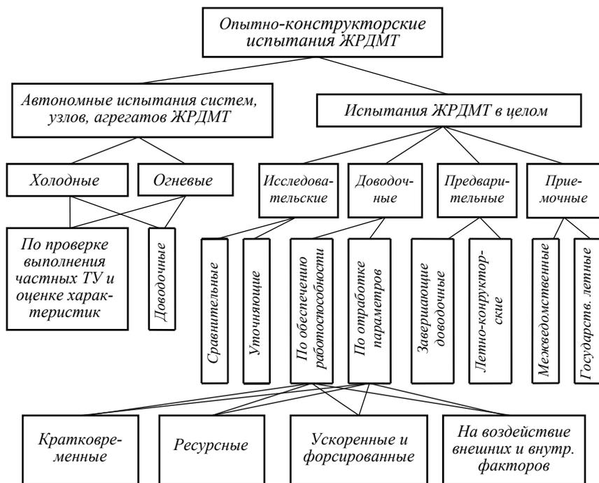
Рисунок 3.1 – Классификация опытно-конструкторских испытаний ЖРДМТ
