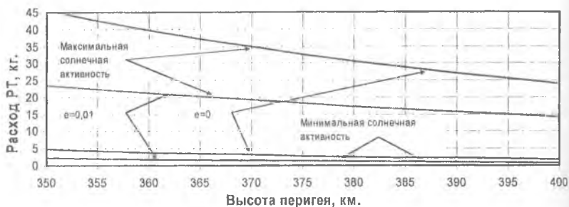
Рис. 2. Зависимости расхода рабочего тела (РТ) в год для различных уровней солнечной активности
