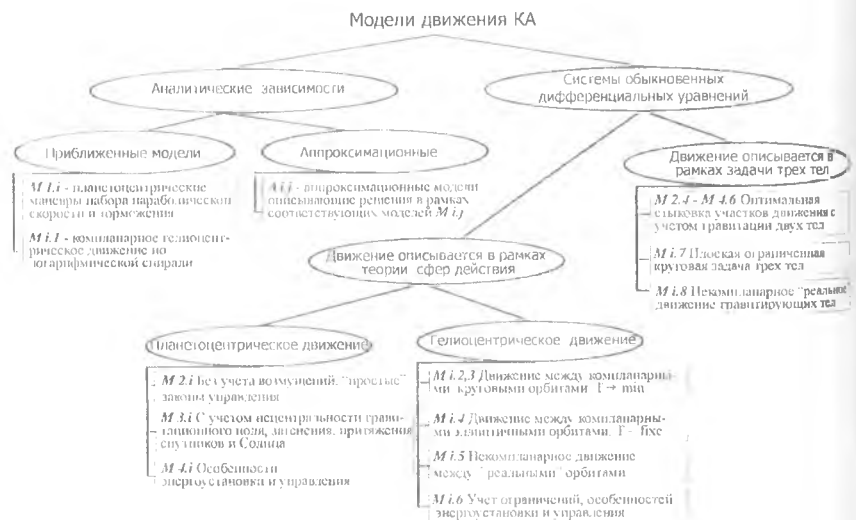
Рис. 1. Классификация моделей движения, использующихся для баллистической оптимизации межпланетных перелетов
