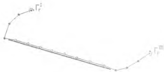
Рис. 1. Вихревая схема при отрывном обтекании передней кромки
