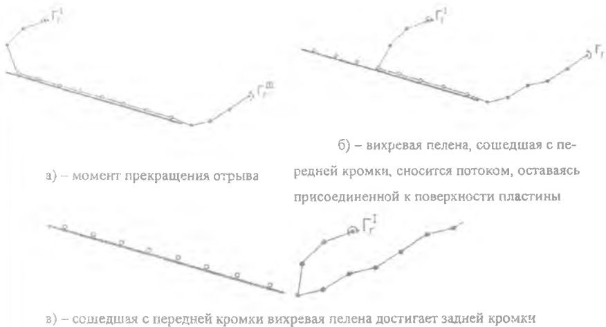
Рис. 2. Изменение вихревой схемы при смене характера обтекания передней кромки
