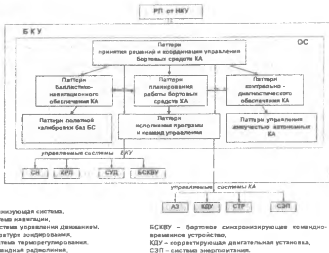
Рис. 4. Общая структура бортового комплекса управления
