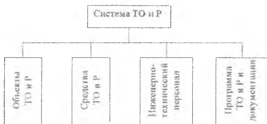
Рис. 1. Структура системы технического обслуживания и ремонта
