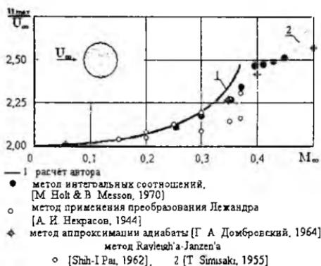
Рис.4 – Зависимость максимальной относительной скорости на цилиндре от числа Маха
