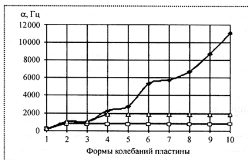
Зависимость частот \alpha колебаний пластины от толщины покрытия h_n : ■ – без покрытия; \blacktriangle – h_n = 0,025 мм; \square – h_n = 0,010 мм
