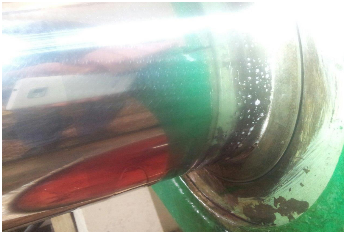
Рис. 1. Утечки азота через пористую структуру хрома из полости оправки с давлением азота 15 МПа
