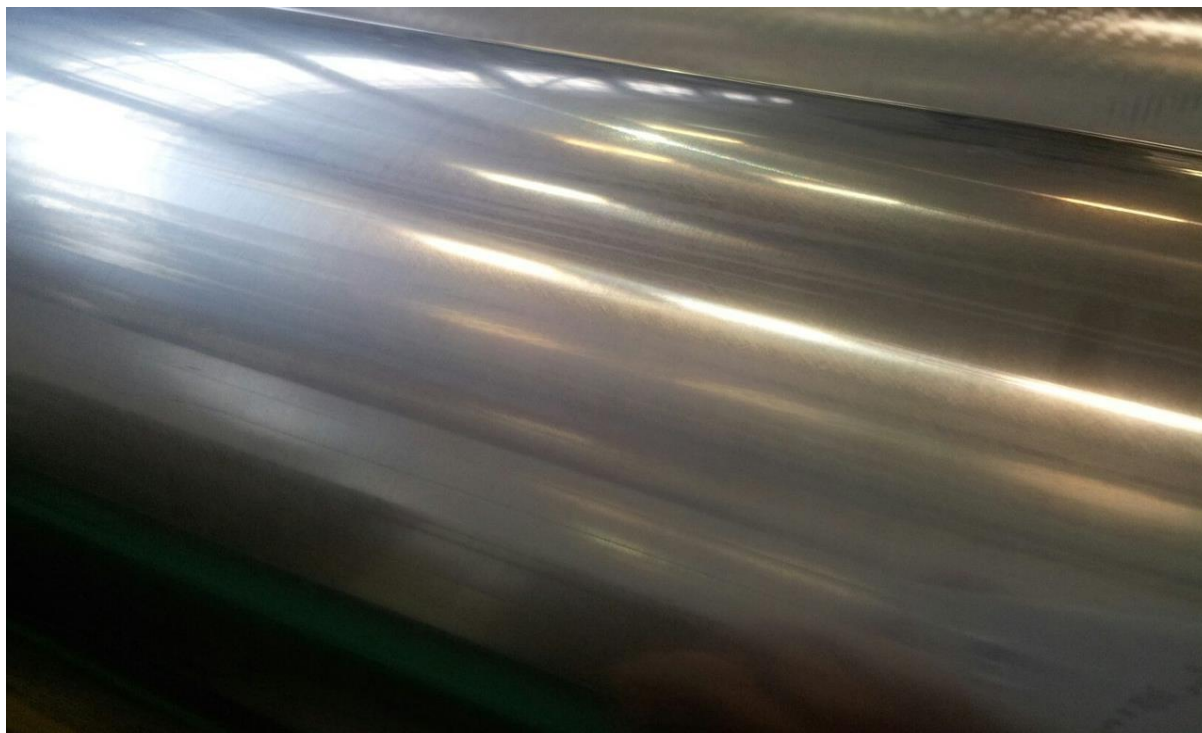
Рис. 2. Поверхность поршня после алмазного выглаживания искусственным алмазом АСПК
