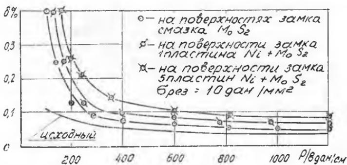
Рис. 6. Зависимость декрементов колебаний лопатки от величины нагрузки на замок ( $\alpha = 30^\circ$ )
