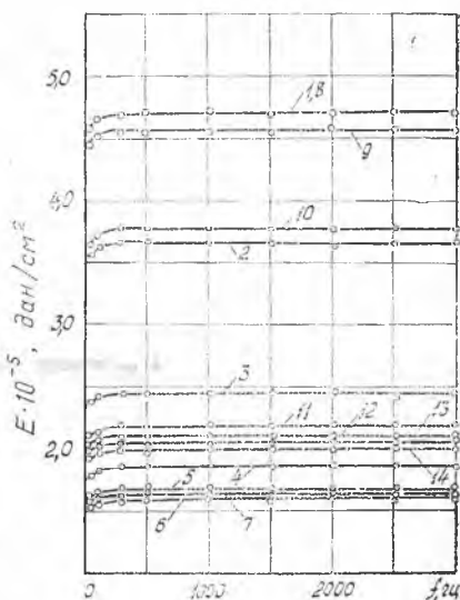
Рис. 3. Влияние частоты на динамический модуль упругости стеклопластика ЭТФ-ВМ:
