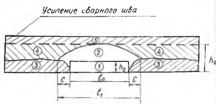
Рис. 2. Строение излома образца с непроваром:
