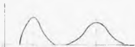
Фиг. 2. Характер изменения случайной погрешности с ростом систематической погрешности.
