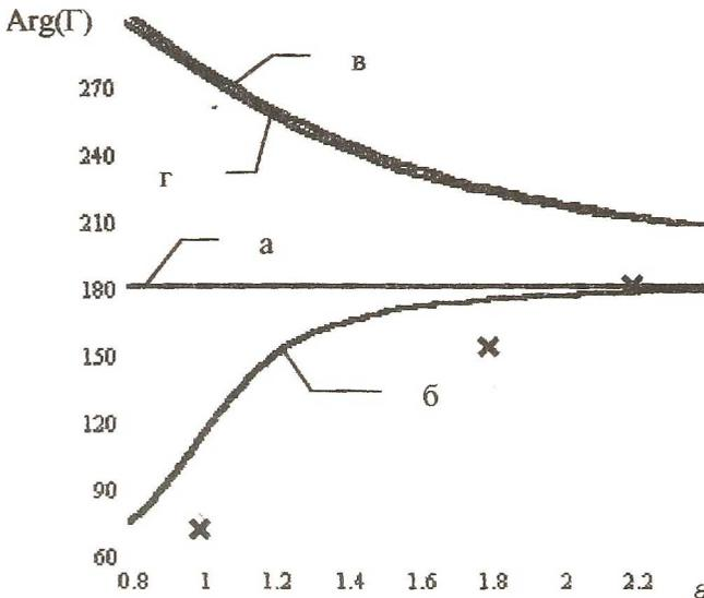
Рис.2. Зависимость фазы коэффициента отражения открытого конца волновода от диэлектрической проницаемости примыкающей среды.
