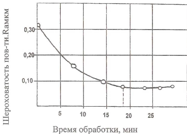
Рисунок 2 - Динамика снижения шероховатости поверхности образцов из сплава ЭП718ВД обработанных методом ЭХО+УЗО.
