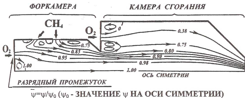
Рис. 1. Структура течения в камере сгорания
