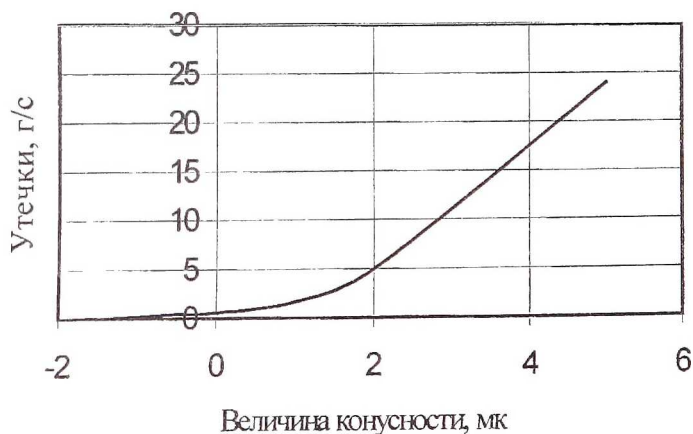
Рис. 7. Влияние конусности уплотнительной поверхности на характеристики уплотнения
