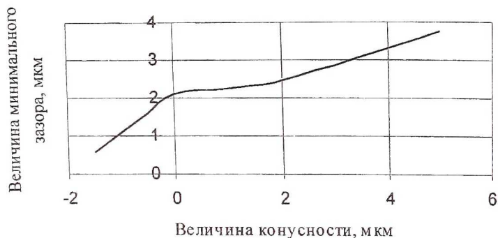
Рис. 6. Влияние конусности уплотнительной поверхности на характеристики уплотнения
