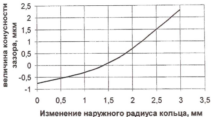
Рис. 5. Влияние геометрии кольца на величину деформации
