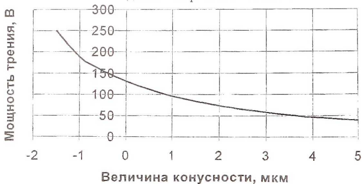
Рис. 10. Изменение мощности трения при различной форме зазора. Поэтому тепловая задача является сходящейся.
