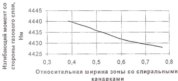
Рис. 9. Изменение изгибающего момента при изменении длины спиральных канавок
