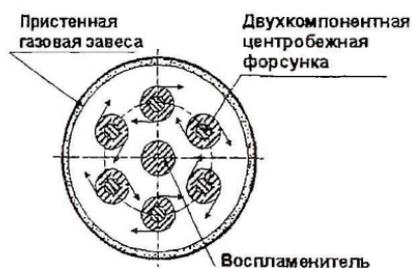
Рис. 1. Схема форсуночной головки
