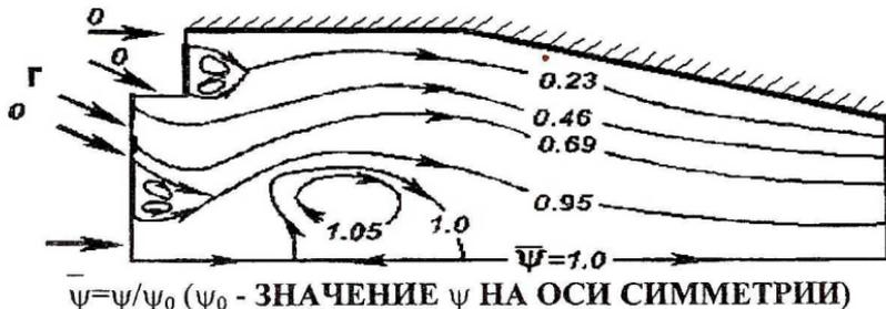
Рис.3. Структура течения рабочего тела в камере сгорания
