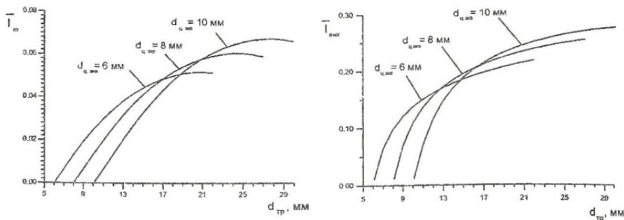
Рисунок 5 - Зависимость оптимальных значений относительных длин входного  $\bar{l}_{вх}$  и выходного  $\bar{l}_{вых}$  конусных участков инерционного канала гасителя от диаметра подводящего трубопровода  $d_{тр}$  и эквивалентного диаметра цилиндрической части  $d_{ц. экв}$
