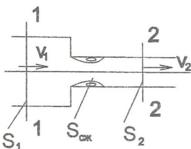
Рисунок 3 - Внезапное сужение трубопровода
