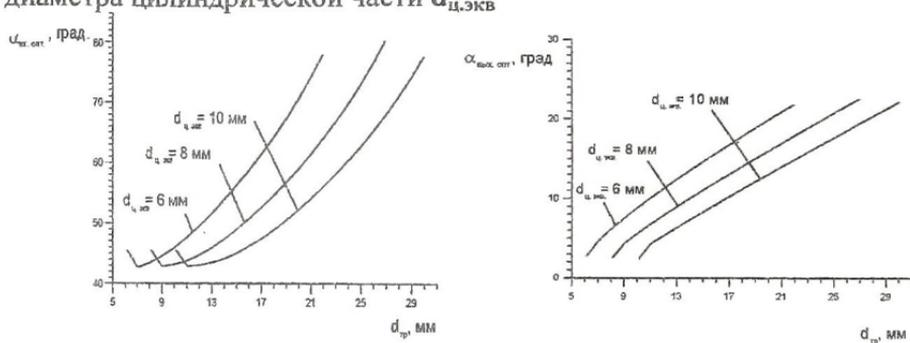
Рисунок 6 - Зависимость оптимального угла входного  $\alpha_{вх}$  и выходного  $\alpha_{вых}$  конусных участков инерционного канала гасителя от диаметра подводящего трубопровода  $d_{тр}$  и эквивалентного диаметра цилиндрической части  $d_{ц. экв}$ .
