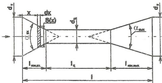
Рисунок 4 - Расчетная схема инерционного канала
