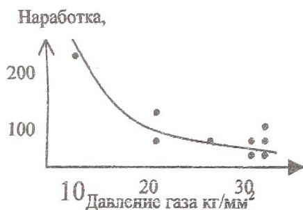
Рисунок 6 - Зависимость степени окисляемости покрытия от давления газа
