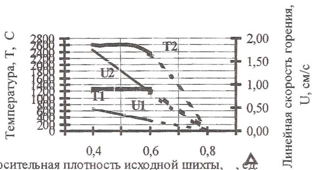
Рис. 7. Зависимость параметров процесса горения от относительной плотности исходной шихты: U1, T1 - скорость и температура реакции восстановления; U2, T2 - скорость и температура процесса азотирования
