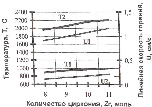
Рис. 1. Зависимость параметров процесса горения о количественного соотношения компонентов: U1- скорость реакции восстановления; T1-температура реакции восстановления; U2 скорость процесса азотирования; T2- температура азотирования
