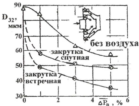
Рис. 8. Влияние направления закрутки воздуха в завихрителях на СДК
