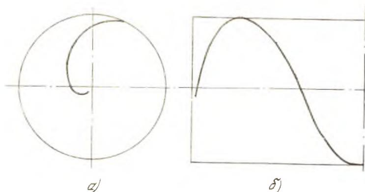
Р и с. Траектория движения частицы аэрозоля: а - по радиусу вихревой камеры, б - по длине вихревой камеры
