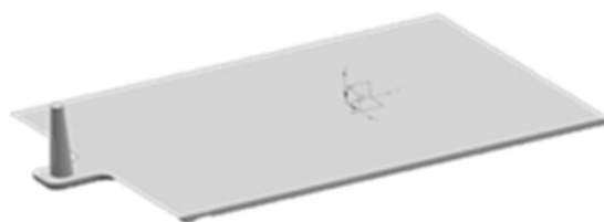
Рисунок 1 – Трёхмерная геометрическая модель литниковой области плоской пластины
