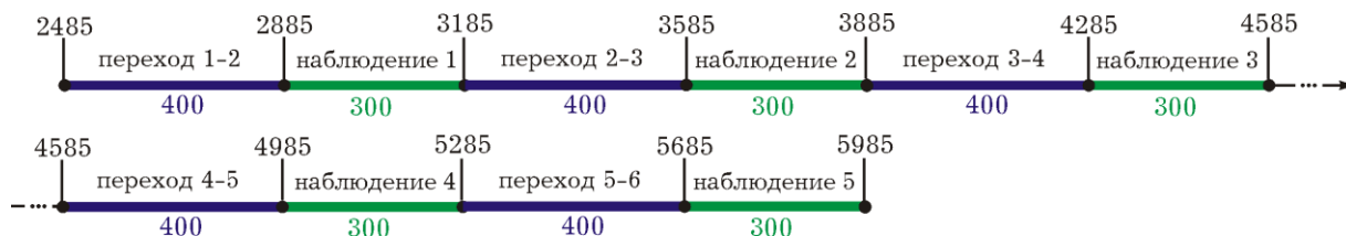
Рис. 2. Временная диаграмма перелётов КРМ и наблюдений состояния спутника
