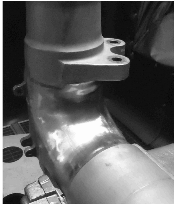
Рисунок 2 – Дробеструйная упрочняющая установка (а); упрочняемая зона траверсы Ан-72 (б)
