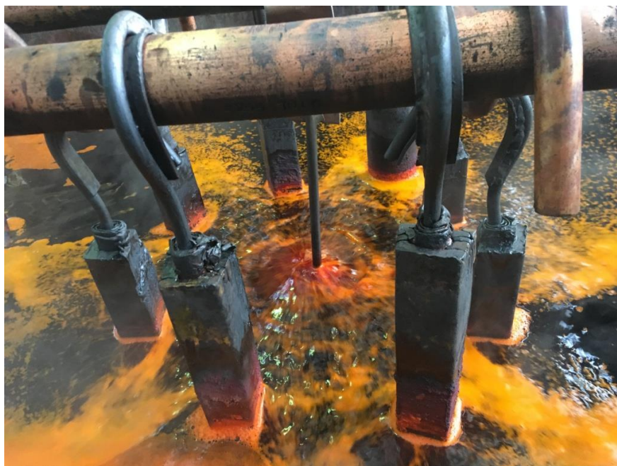
Рис. 1. Расположение анодов в процессе хромирования
