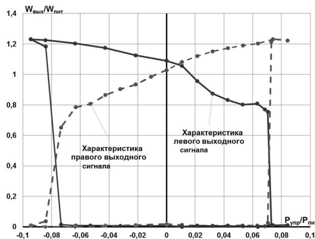
Рисунок 3 – Графики зависимостей относительных расходов в выходных каналах от относительных давлений в управляющих каналах
