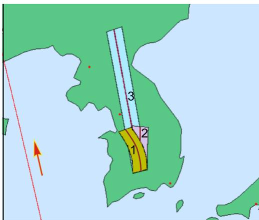
Рис. 3. Маршруты съёмки: 1 – с выравниванием, 2 – ортодромическая, 3 – трассовая
