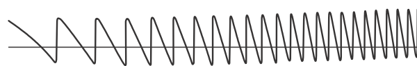
Рис. 5. Общий вид профиля дифракционной линзы с фокусным расстоянием 70 мм и диаметром 10 мм
