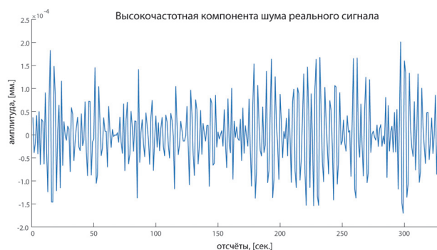
Рис. 4. Высокочастотный шум, извлечённый из реального сигнала с помощью дискретного вейвлет-преобразования
